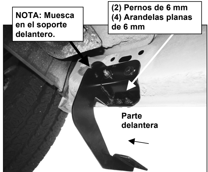
(Fig. 11) Fije el soporte a la parte trasera de la soldadura por pellizco (modelos con orificios de fábrica únicamente en soldadura por pellizco).
